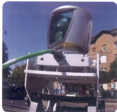
■ Az autóra szerelt LIDAR kamera adatgyűjtés közben
