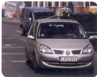
■ A SZTAKI autóra szerelhető LIDAR kamerája adatgyűjtés közben
