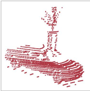
5.10 ábra Objektum kinyerése egyrétegű ráccsal
