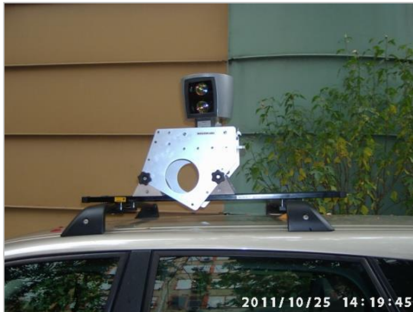
2.2 ábra Az MTA SZTAKI Velodyne típusú szenzora
