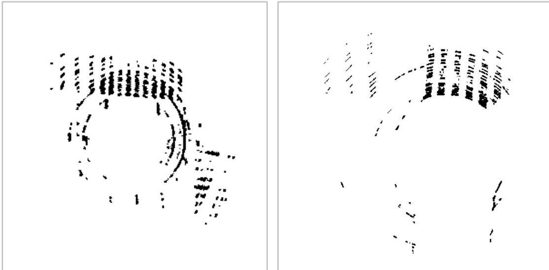
6.4 ábra Projektált pontfelhőn végrehajtott dilatació
